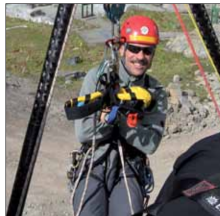
Dyneema©-Seil wird in Kombination mit dem Zweibein verwendet.
