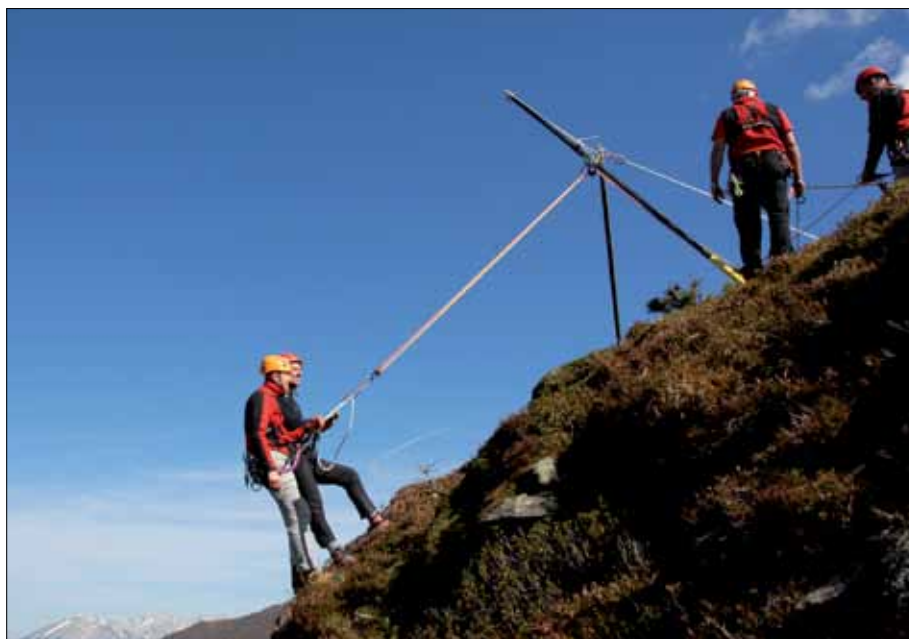
Dyneema©-Seil wird in Kombination mit dem Zweibein verwendet.
