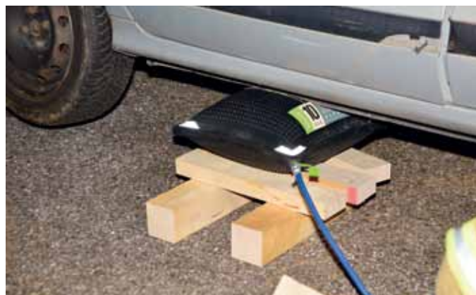
Mittels Druckluft kann ein Objekt gehoben werden um eingeklemmte Personen darunter befreien zu können.
