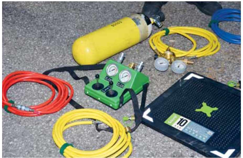
Druckluftflasche, Steuereinheit, Druckluftschläuche und ein Hebekissen – all dies ist für die Bedienung eines Hebekissensatzes notwendig. Maximal zwei Hebekissen können auf einmal gesteuert werden.
