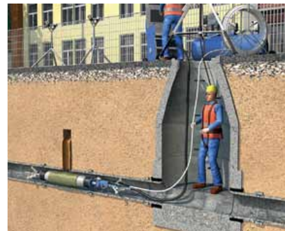
So läuft eine Inliner-Sanierung ab.
