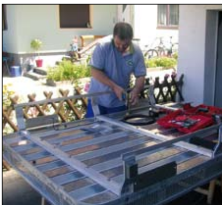
KFZ-Meister Martin Freisinger bei der Montage der LED-Leuchten an den Dachträger.
