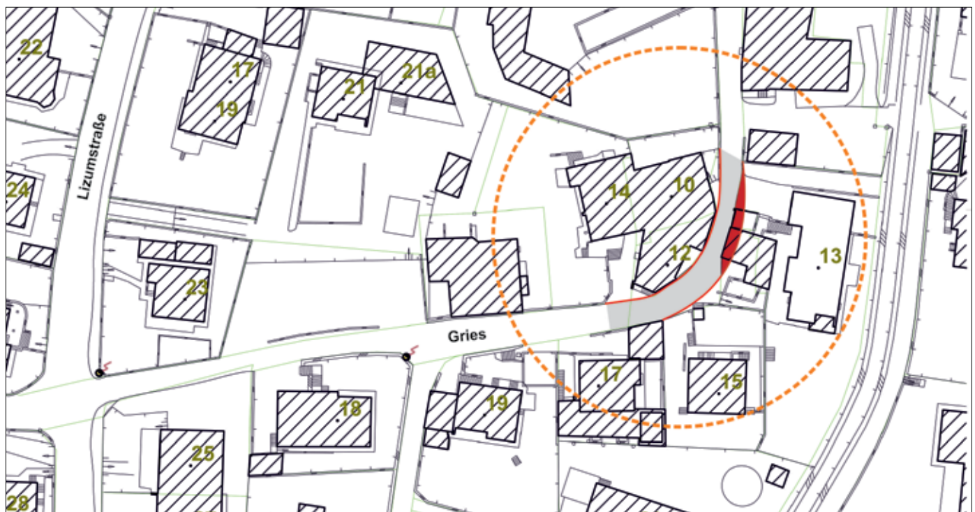
Detailansicht des Straßenausbaues – die rot markierte Fläche entspricht der Verbreiterung.
