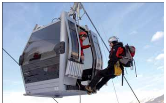
Über das Förderseil wird der Bergretter von der Stütze zur Gondel abgelassen.
