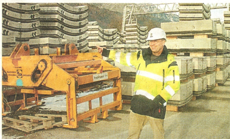
BEG-Sprecher Martin Pellizzari bei der Lagerstätte für die Tübbinge in Stans. Die Betonteile dienen zum Auskleiden der Tunnelröhre.
