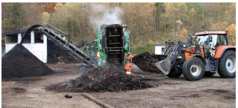
Nachdem der Rotteprozess abgeschlossen ist, werden durch das Sieben gröbere Bestandteile entfernt. Dadurch entsteht als Endprodukt unsere feine und hochwertige Komposterde.
