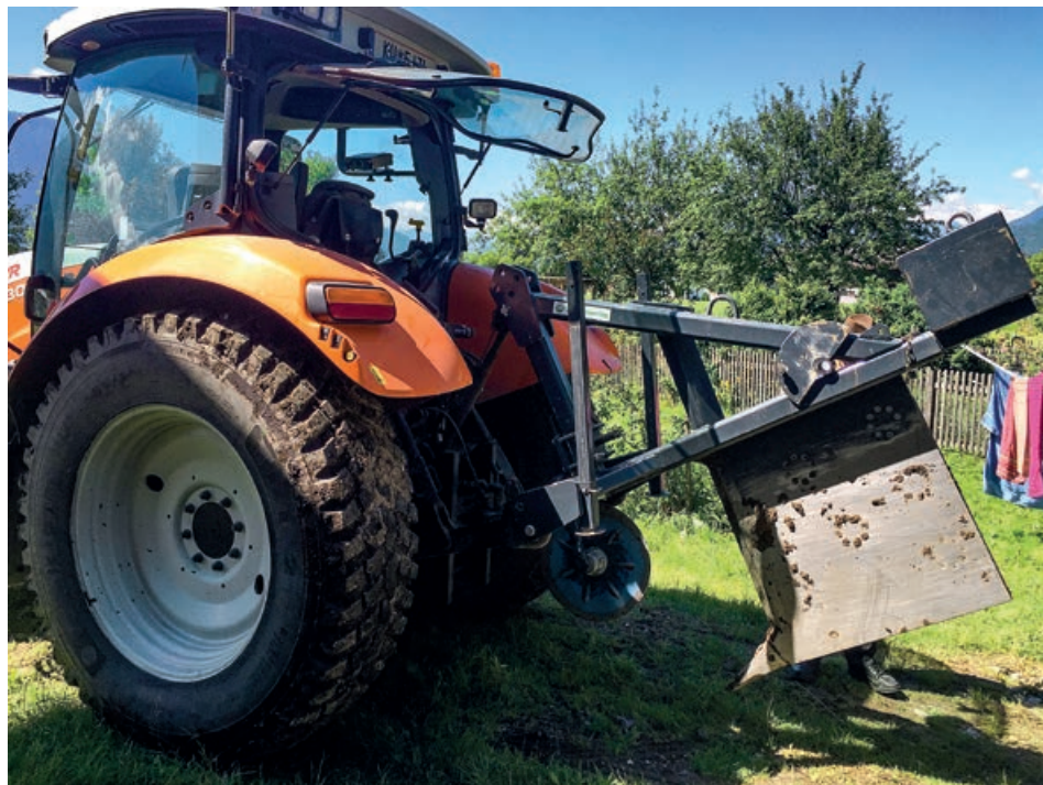
Teilweise wurden die Grabungsarbeiten mittels Pflug durchgeführt.
