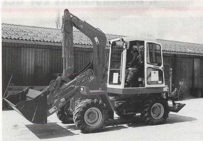
gebaut sind. Durch seine große Wendigkeit ist ein Rundumsatz möglich. Natürlich ist auch eine Frontladereinrichtung am Fahrzeug angebracht. Der neue Baggerlader wird vorallem für Wasserleitungs- und Kanalgrabungen im Einsatz stehen. Er ist aber auch für die Schneeräumung bedingt verwendbar.
