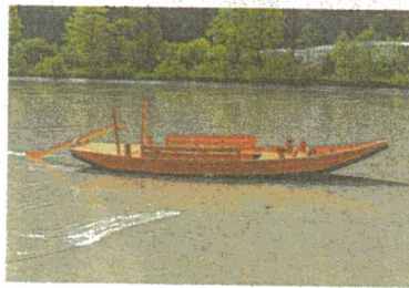
Zehn Meter lang und drei Meter breit ist die neue Innfähre.
