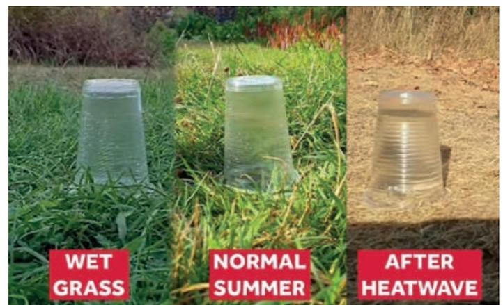
Experiment nach 52 Sekunden: Das Wasser im normalen Sommer ist ebenfalls versickert. Beim Gras nach der Hitzewelle ist nichts versickert. Der Boden ist nahezu wie zubetoniert.
