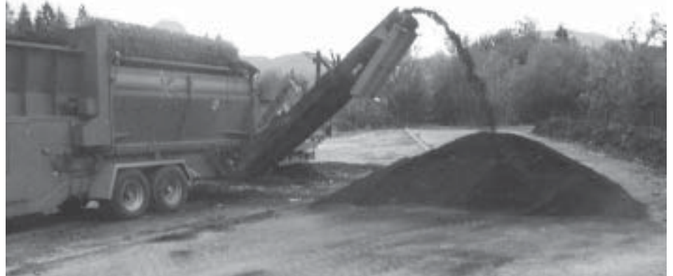
Mit dem auf der Schanzer Lahn im Einsatz stehenden Kompostsieb wird qualitativ hochwertige Komposterde gewonnen.
