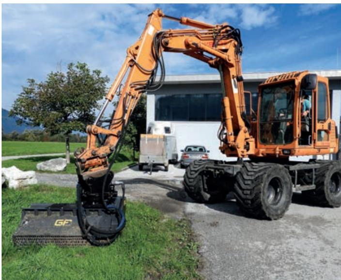
Der Takeuchi-Bagger mit dem neuen Mulchgerät.
