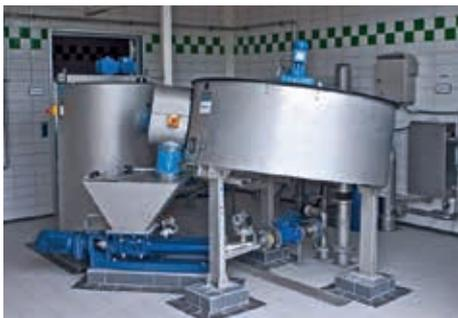
Maschinelle Schlammwindung mit Scheibeneindicker.
