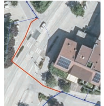
Auszug aus dem GIS-System der Gemeinde Ebbs, in dem das Wasserleitungsnetz der Gemeinde abgebildet ist. Rot eingetragen die neu errichtete Wasserleitung, blau strichliert dargestellt ist die Lage der stillgelegten Wasserleitung.
