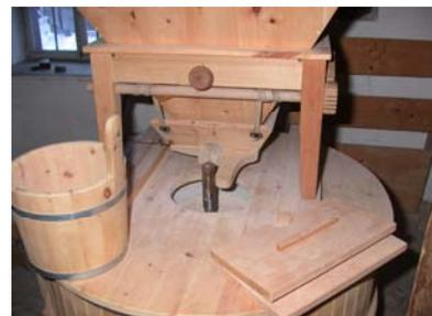
Beim Steinmahlwerk handelt es sich um 2 übereinander liegende Steine. Der Untere ist fix, der Obere dreht sich. Mit Hilfe eines Hebels (o.M.) wurde der Abstand der Steine bei jedem Mahlgang verkleinert.
