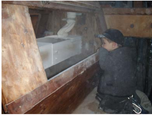
Das Mehl fällt durch den Mehleinlass in den Mehlkasten .
