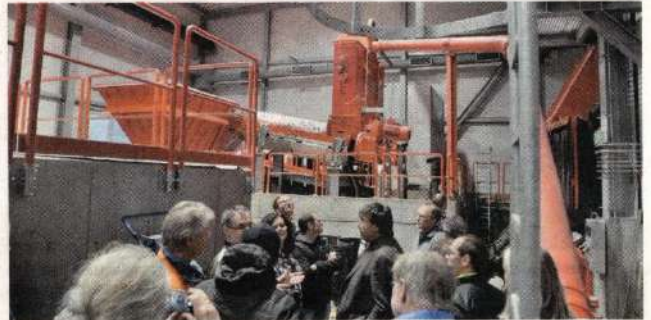
In den sogenannten Schneckenpressen wird das bereits Fermentierte auf 30 bis 35 Prozent Trockensubstanz gepresst.
