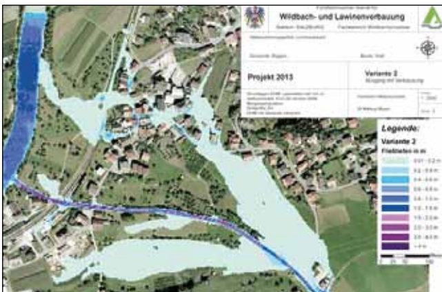
Vermurungssimulation in angenommenem Verklauungsfall
