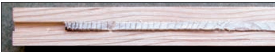
Abb.2: präparierter Bohrkern (5mm) - bereits in Holzleiste eingeleimt
