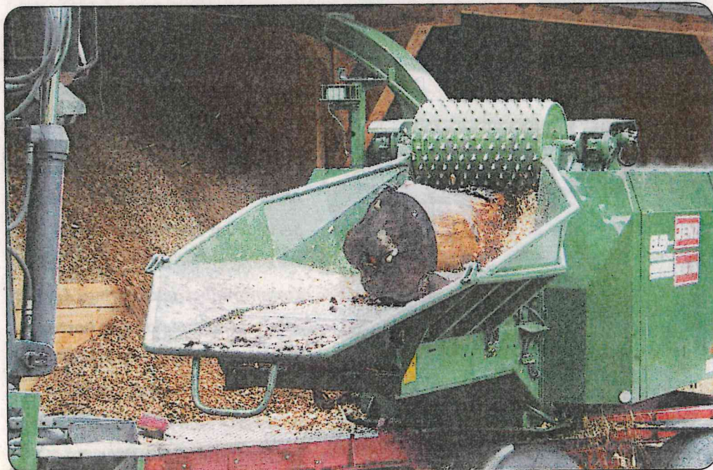
Bäume mit bis zu 70 cm Durchmesser sind mit dem neuem Großhacker in Tirol nach dem Jahreswechsel kein Problem mehr.
