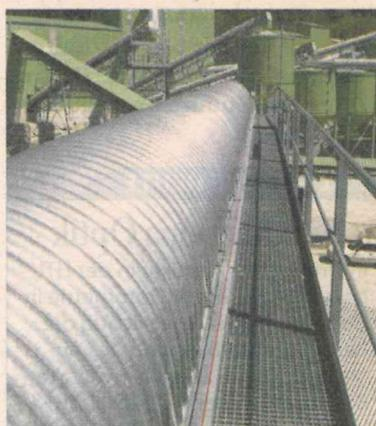
Die Zulieferung des Schotters erfolgt über eingehauste Förderbänder. Nach der Verarbeitung werden die Splitte in den grünen Silos (Hintergrund) gelagert.
