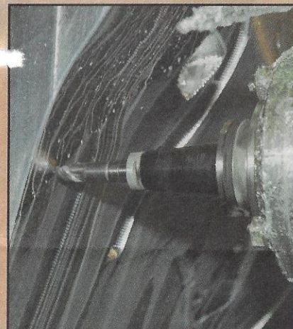
Fräsen in höchster Eleganz. Für die Maschinen wird im Winter nachts die Halle geheizt, damit sich die Genauigkeit nicht verändert.
