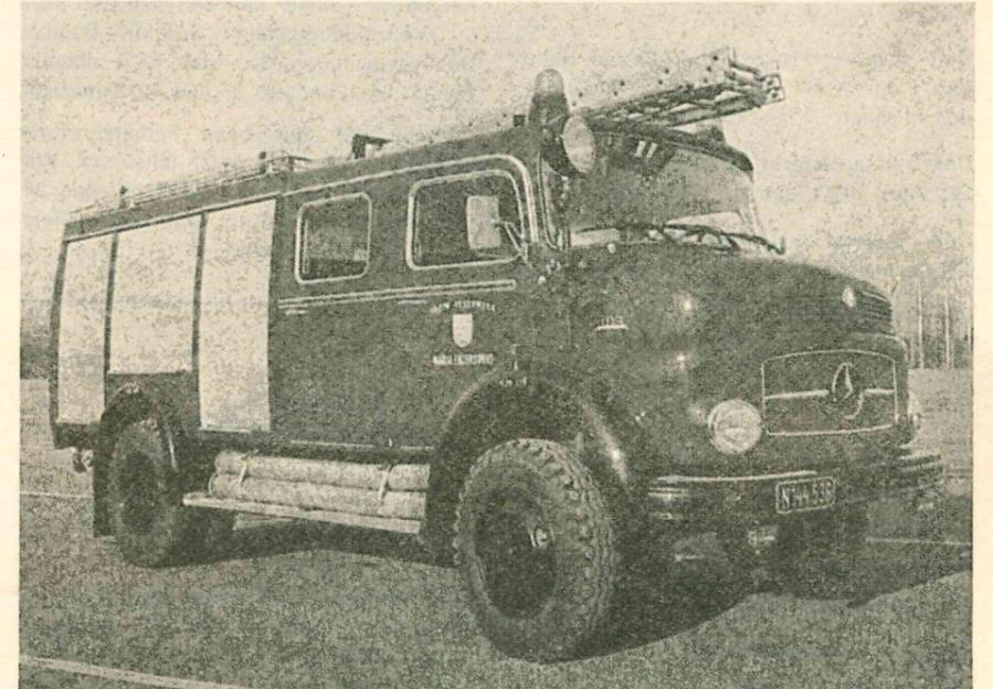
TLF 2000, Type MERCEDES 1113/B 36 Allrad Tankinhalt 2,500 Liter Wasser. Statt der Leitern ist auf der Tankplattform ein Wasserwerfer (Monitor) mit einer Wurfweite von ca. 60 m und einer Minutenliterleistung von max. 1.600 Liter montiert
