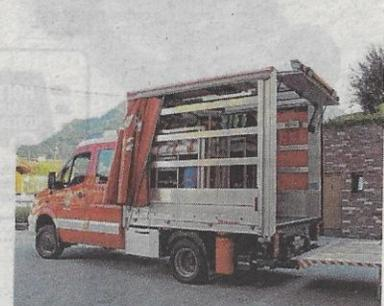
Die Seitenplane ist spannbar und kann leicht geöffnet werden.
