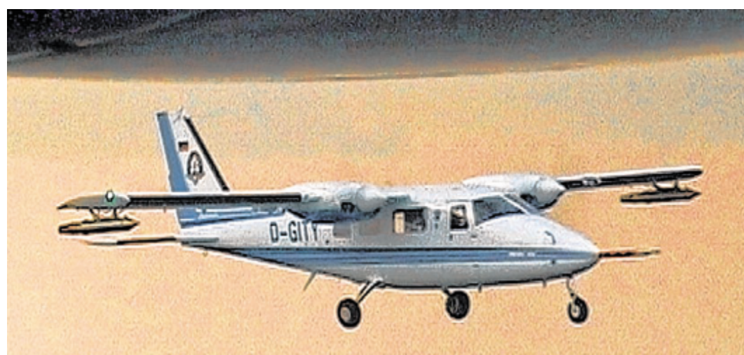
An den Spitzen der Tragflächen des Hagelfliegers sind Silberjodid-Generatoren montiert.
