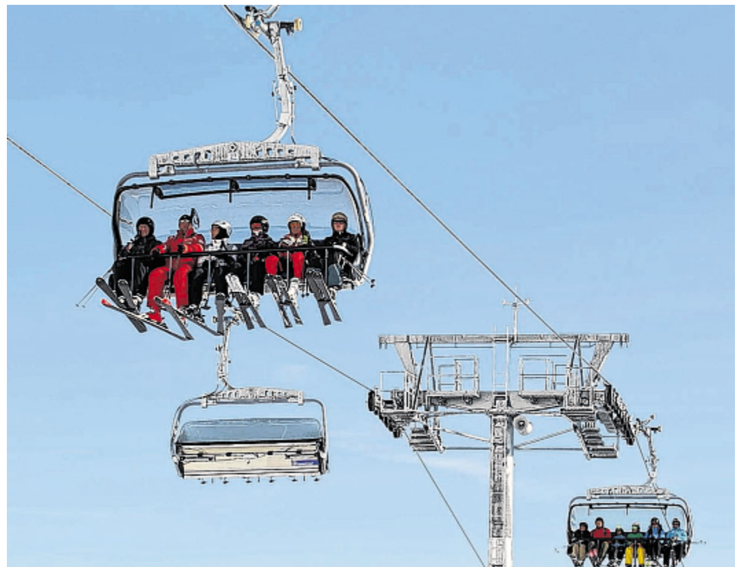
Die neue kuppelbare Ger-Sesselbahn Moseltret X-Press mit Wetterschutzhauben und Sitzheizung ersetzt die DSB Krumbach im Bereich Gerlos. Sie hat eine Förderleistung von 2409 Personen pro Stunde. Foto: Doppelmayr Seilbahnen
