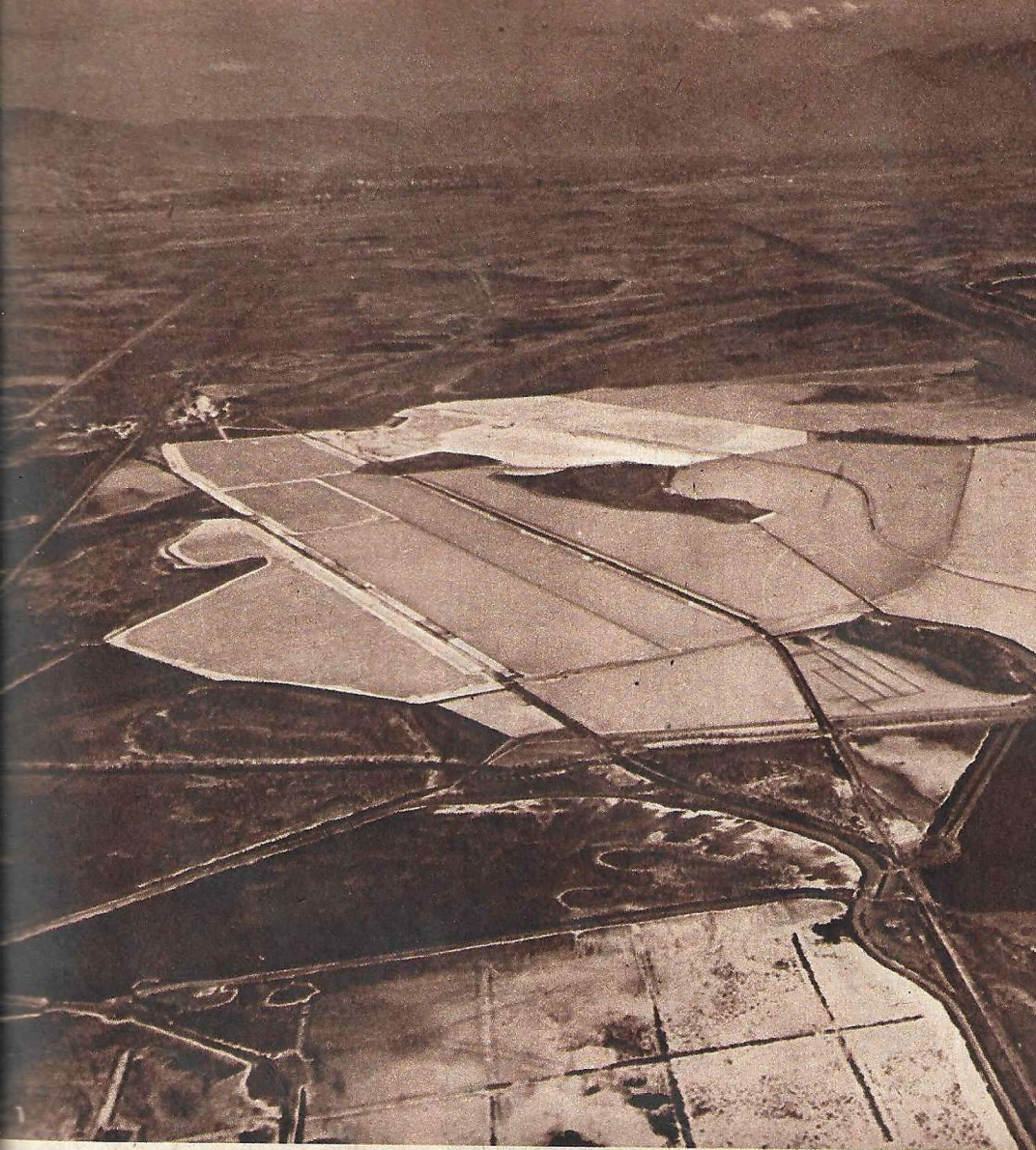
Keine Weizenfarm, sondern eine Salzfarm zeigt diese Luftaufnahme der Umgebung der Ortschaft Saltair in Utah. Das Wasser des großen Salzsees wird in flache Teiche gepumpt und der Verdunstung ausgesetzt.
