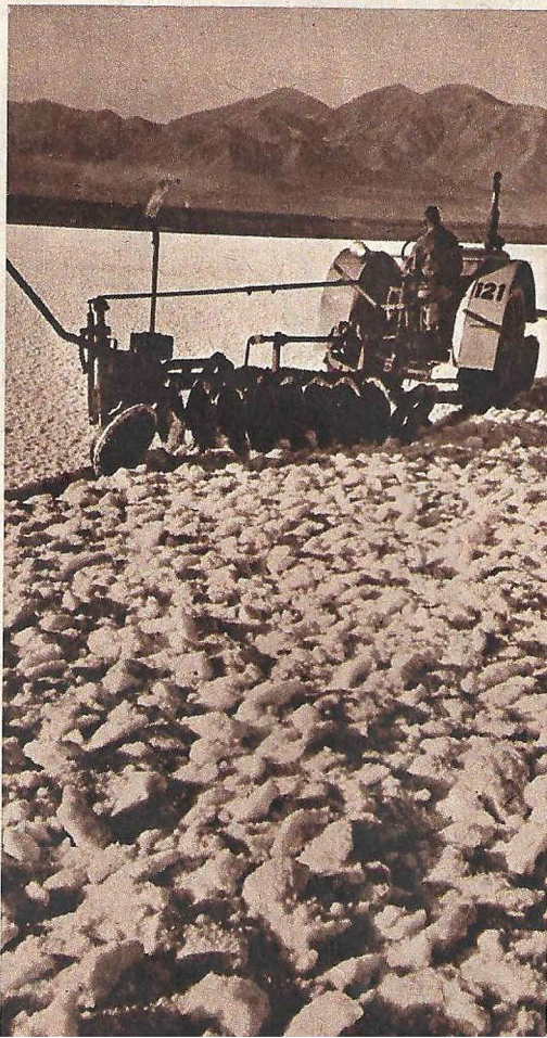
Keine Weizenfarm, sondern eine Salzfarm zeigt diese Luftaufnahme der Umgebung der Ortschaft Saltair in Utah. Das Wasser des großen Salzsees wird in flache Teiche gepumpt und der Verdunstung ausgesetzt.
