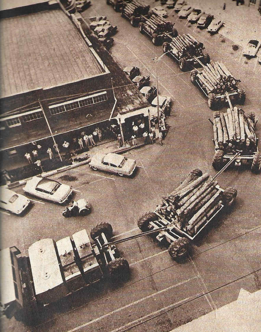
UM JEDES ECK kommt der Frachtzug auf Gummirädern, den eine texanische Firma baute. Jedes der 32 Räder wird durch einen eigenen Elektromotor angetrieben. Auf der „Lok“ befindet sich das Führerhaus für sieben Personen, der 13.000 l-Brennstofftank und zwei Aggregate, die den für den Antrieb nötigen Strom erzeugen. Während einer Probefahrt durch Longview hatte die Bevölkerung sichtlich Vertrauen zu dem neuen Gefährt. Sie parkte ihre Wagen beruhigt am Rande der Teststrecke.
