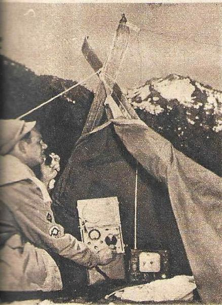
Über Funkfernsprecher stehen die einzelnen Suchgruppen ständig mit dem Flugzeug und untereinander in Verbindung.
