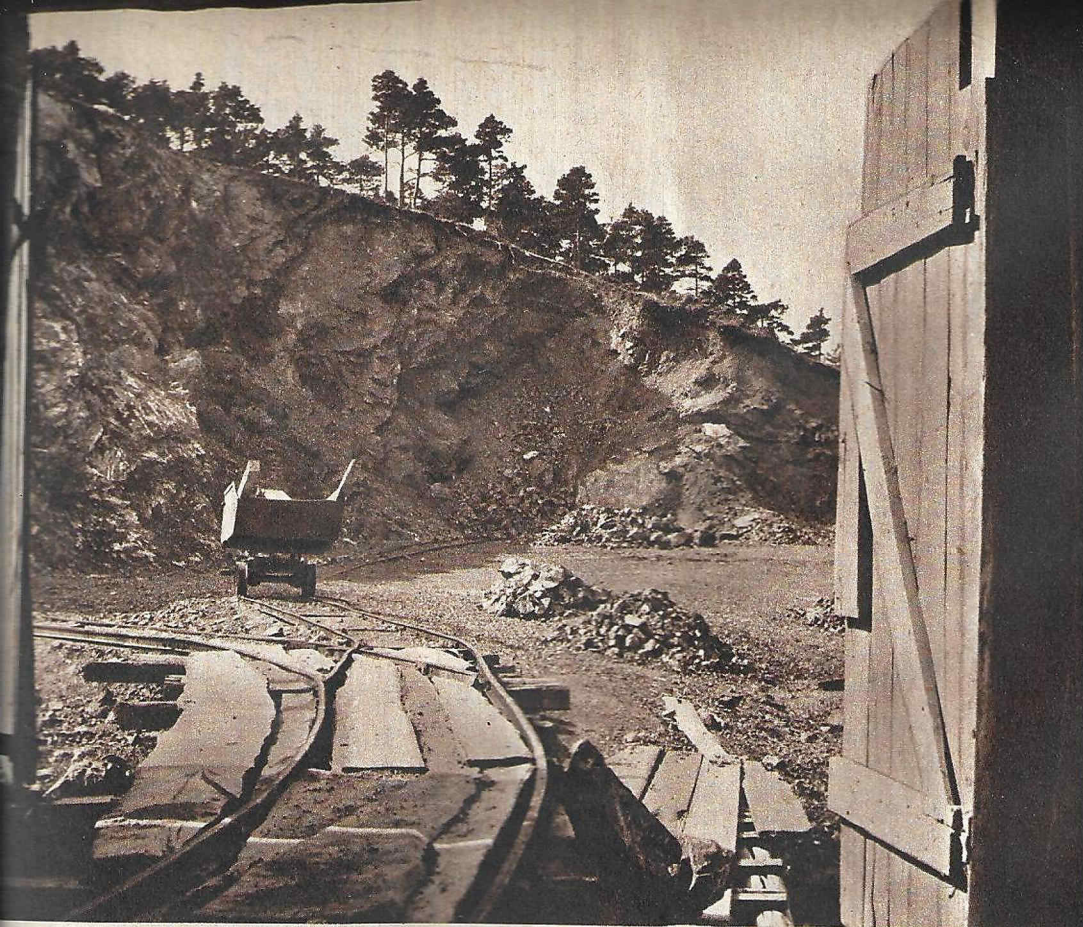
Der Edelserpentin wird durch Abtragen und Absprengen vom Gemeinen Serpentin im Steinbruch (links) oder im Stollenbau gewonnen. Um Beschädigungen zu vermeiden, wird ein Umkreis von einem Meter von dem zu lösenden Stück nicht gesprengt. Etwaige Haarrisse „heilen“ beim zweimonatigen Ablagern der Blöcke (oben).
