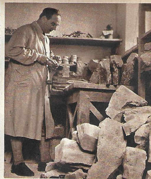
Der Edelserpentin wird durch Abtragen und Absprengen vom Gemeinen Serpentin im Steinbruch (links) oder im Stollenbau gewonnen. Um Beschädigungen zu vermeiden, wird ein Umkreis von einem Meter von dem zu lösenden Stück nicht gesprengt. Etwaige Haarrisse „heilen“ beim zweimonatigen Ablagern der Blöcke (oben).
