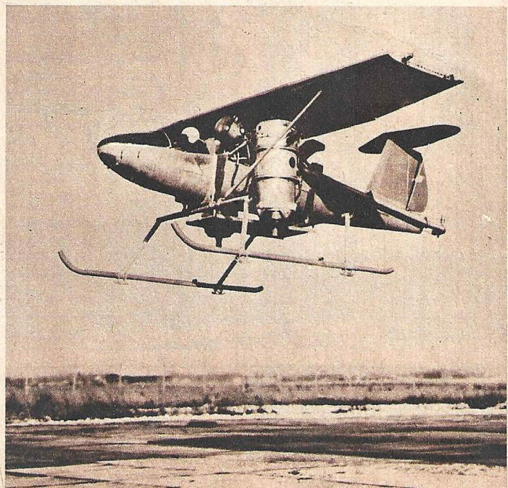
Senkrecht starten und landen kann dieses Düsenflugzeug der amerikanischen „Bell“-Flugzeugwerke. Die Düsenmotoren an beiden Seiten des Rumpfes werden zu diesem Zweck in die Vertikale gekippt, während sie beim Geradeausflug horizontal stehen. >
