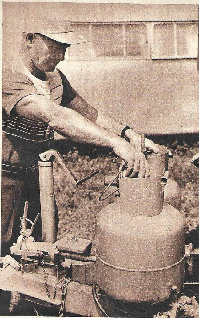
Durch Propangasflaschen , die auf der Deichsel des Wohnwagens, montiert sind (Bild), sowie Akkumulatoren im Wageninneren ist die „Energieversorgung“ sichergestellt.
