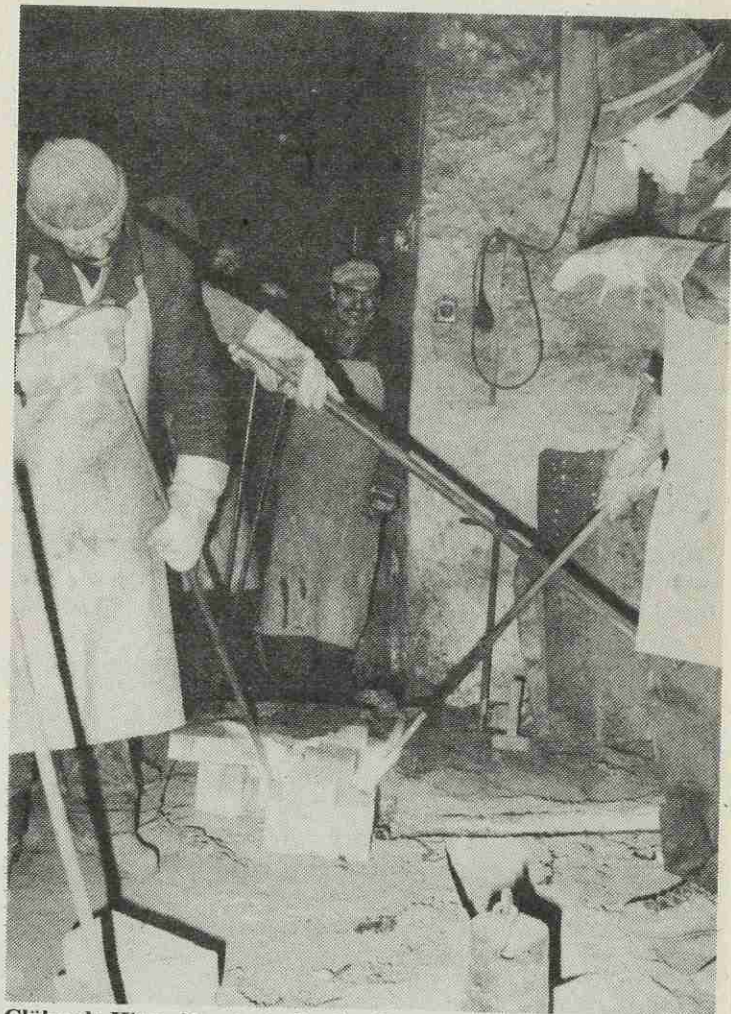
Glühende Hitze, Rauch, beißender Geruch, Schweiß, kräftige Arme, die zupacken können — das ist die Szenerie beim Glockengießen in der Fa. Grassmayr in Innsbruck. Freitag wurden die zwei neuen Kirchenglocken für Feichten gegossen.
