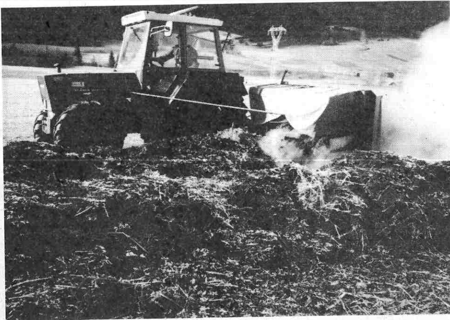
Besonders stolz ist Heinz Grießer auf seine selbstkonstruierte »Erfindung«. Aus zwei alten Miststreuerwellen und Alteisen entstand eine funktionstüchtige Kompostwendemaschine. Dadurch konnte der Anschaffungspreis auf ein Zehntel gesenkt werden.
