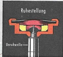
Querschnitt der Junghans-Stoßsicherung in starker Vergrößerung.
