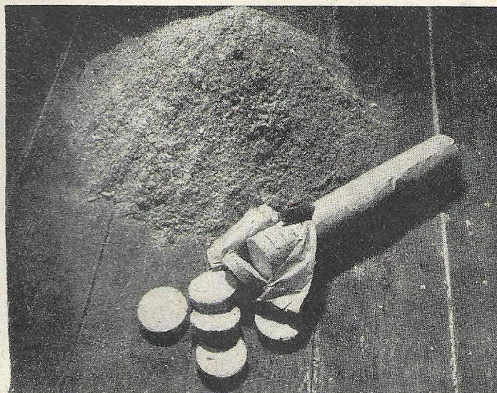
Nach dem Pressen werden die Briketts entweder in Rollen verpackt oder offen verkauft. Mit 4500 Kalorien haben sie den gleichen Heizwert wie Braunkohlenbriketts, sind jedoch billiger als dieselben. Mit einem spezifischen Gewicht von 1,7 sind sie schwerer als Eichenholz.
