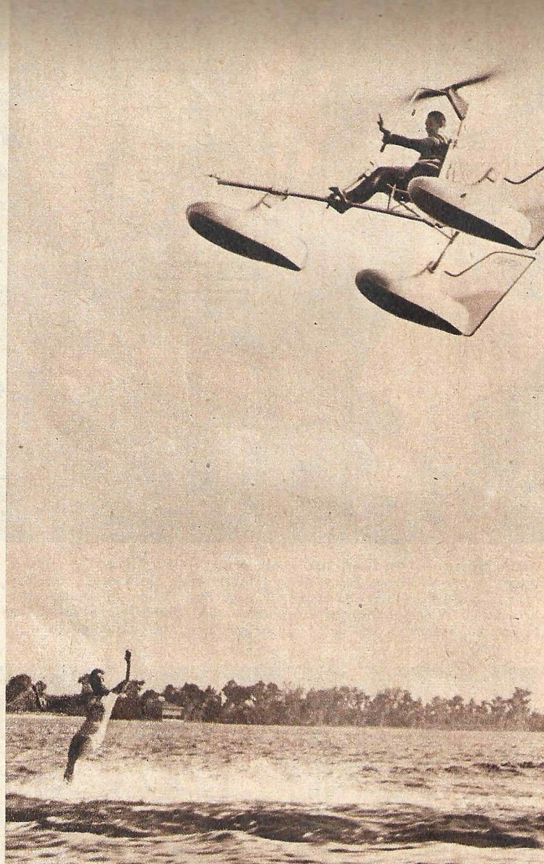
Die ersten Flugversuche mit dem selbstkonstruierten Segel- hubschrauber unternahm der Amerikaner Igor Benson am Strande von Florida. Das Segelflugzeug hat anstelle von Tragflächen einen zweiblättrigen Rotor, der sich zu drehen beginnt, sobald sich die Maschine — von einem Schnellboot gezogen — in die Luft hebt.
