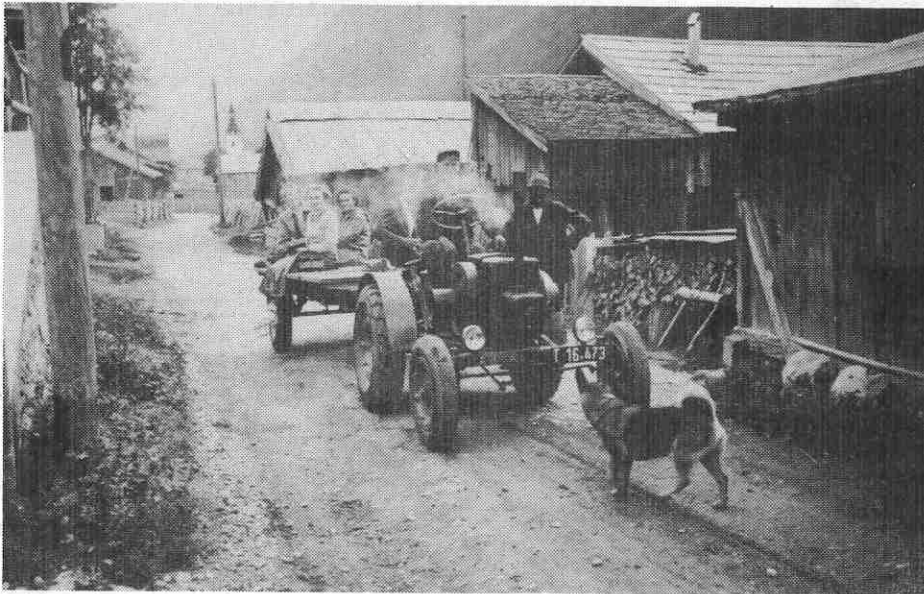
◀ Der erste Traktor von Mathon, um 1950. Xaver Jehle kaufte als erster Mathoner im November 1948 einen Traktor. Es handelte sich dabei um die erste Ausgabe der Lindner Traktoren mit Verdampfungskühlung.
