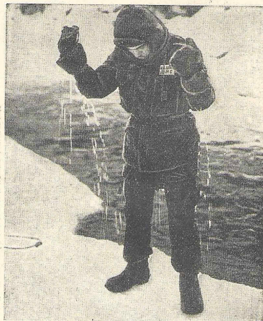
Einem eiskalten Bad entsteigt hier ein Korporal, der einen Kälteschutzanzug aus schaumgummihähnlichem Material trägt. Obwohl die Badezeit 25 Minuten betrug, erreichte seine Körpertemperatur nach einigen Freübungen wieder normale Werte.
