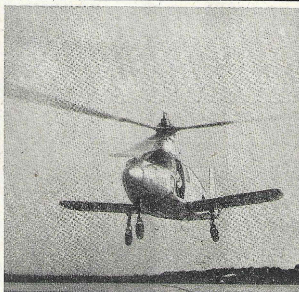
Einen Hubschrauber, der nach dem Start als gewöhnliches Flügelflugzeug weiterfliegt, entwickelte die SNCASO, Frankreichs zweitgrößte, mit Marshall Plan Hilfe...
