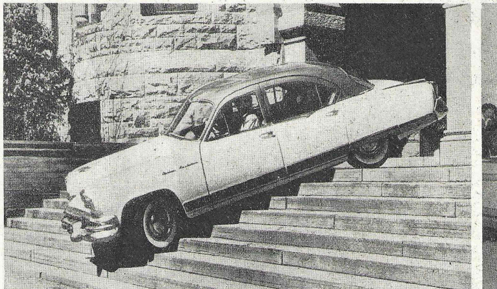
Tunlich zu vermeiden ist die Behandlung, die diesem Automobil zuteil wird. Das Treppabfahren dient jedoch als Beweis für die Vorteile der neuen Servosteuerung, mit der nun die meisten amerikanischen Autos ausgestattet sind. Eine gewöhnliche Lenkung würde bei diesem Manöver sicherlich versagen.
