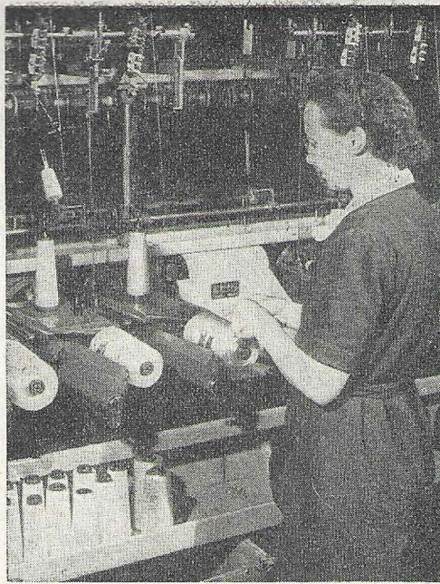
Bevor das Garn auf die Webstühle kommt, wird es maschinell umgespult. Es werden nur standardisierter Crêpe de Chine und Futterseide erzeugt.
