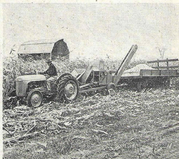
Eine Maiserntemaschine bei der Arbeit. Sie pflückt die Kolben, enthüllt sie und lädt sie mit einem Förderband auf einen Anhänger.
