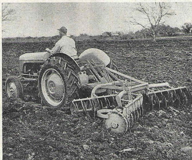
Ein Traktor vor einer Tandem-Scheibenegge. In den USA laufen derzeit 4,4 Millionen Traktoren, 765.000 werden jährlich neu erzeugt.
