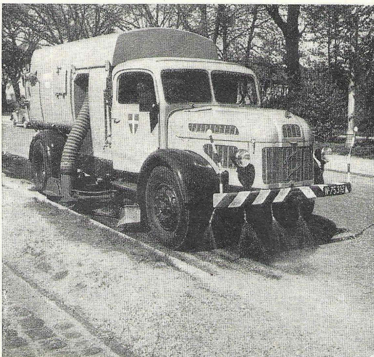
Vom Straßenrand, wo sich erfahrungsgemäß der meiste Staub ansammelt, nimmt ein von der Gemeinde Wien probeweise in Dienst gestellter Kehrwagen den Schmutz auf. Ein kleiner rotierender Besen wirbelt den Kehricht auf, der dann sofort von dem dahinter montierten Saugrohr aufgenommen wird.
