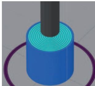
dann erhält man am Ende einen zylindrischen Turm, der im 3D Druckverfahren hergestellt wurde. Die Dicke der einzelnen Spiralen liegt zwischen 0,1 und 0,4mm. Das Kernstück dieser „Heißklebepistole“ nennt man Druckdüse.
