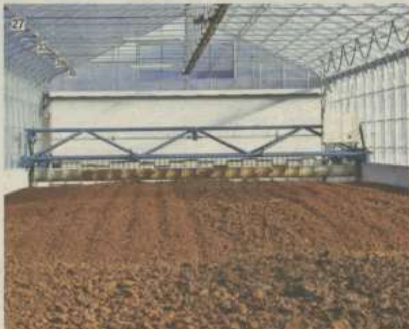
Ein „Schubwender“ verteilt den Klärschlamm zunächst gleichmäßig und dreht ihn anschließend regelmäßig um.
