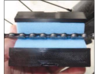
bis sie das nächste Mal zum Einsatz kommt. Die grobe Schwammseite kann bei Bedarf auch zum Reinigen der Kette verwendet werden, bevor man mit der feinen Schwammseite die Kette neu ölt.
