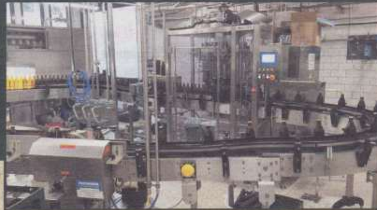
Flaschenfüllerei mit Flaschenwaschmaschine, Flaschenfüller und Etikettierer
