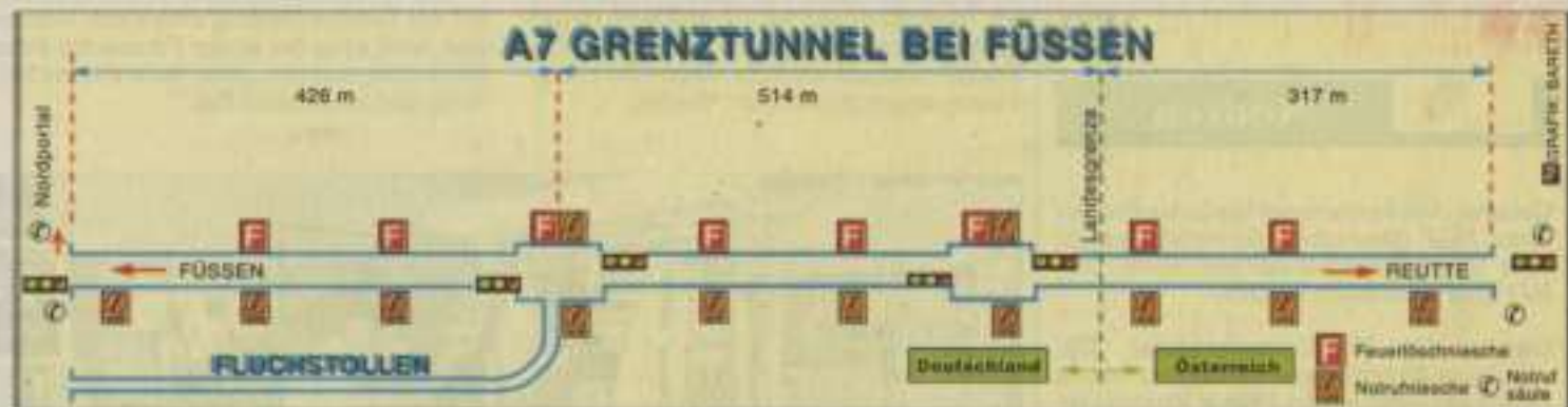
Der Fluchtstollen im 1284 Meter langen A7-Grenztunnel führt nach rund 420 Metern in Richtung Deutschland. Alle 120 Meter sind zudem Feuerlöschnischen mit Hydranten und Notrufnischen mit Feuermeldern, Notrufsprechanlagen und Handfeuerlöschern vorgesehen.
